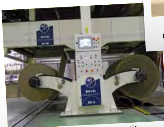
Freni Extreme su gruppo svolgitore BHS Extreme brakes on BHS shaftless roll stand
